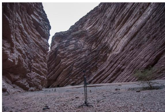
Figura 1: Vista desde el interior del Anfiteatro donde puede apreciarse con claridad la grieta de entrada. En el centro, el micrófono Ambisonics usado para las mediciones junto con la cámara 360.
