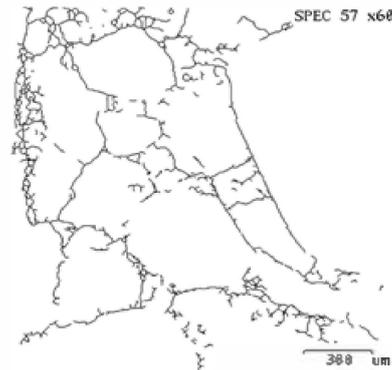
Figura 2: Micro fisuras en concreto.
