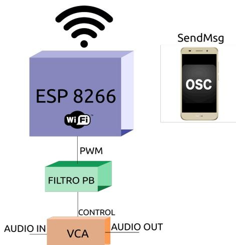
Figura 2. Diagrama general de la solución implementando control con PWM.
