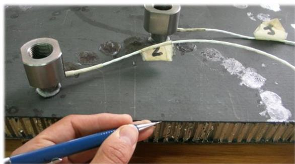
Figura 8: Medición de la isotropía del panel excitando el multilaminado de CFRP en el plano.
