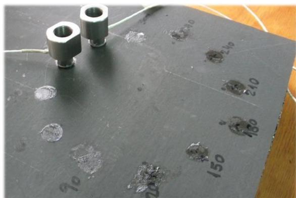
Figura 7: Medición de la isotropía del panel excitando perpendicularmente al multilaminado de CFRP.
