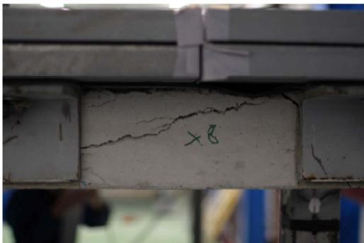
Figura 1: Fisuras visibles en concreto.
