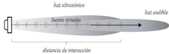
Figura 2: Esquema para interpretar distancia de absorción.
