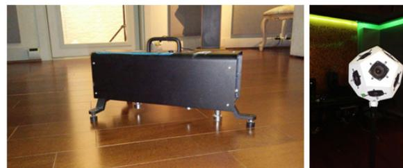
Figura 15: Fuentes sonoras utilizadas para las mediciones de rendimiento según ISO 16283-1 y 16283-2.
