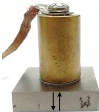
Figura 1: Disposición de elementos en la medición por pulso-eco.
